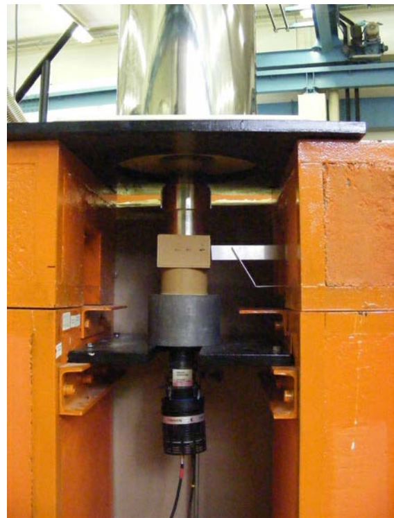
Az in-beam mérőhely alsó része oldalnézetben (neutronnyaláb bevezetés és detektor)
