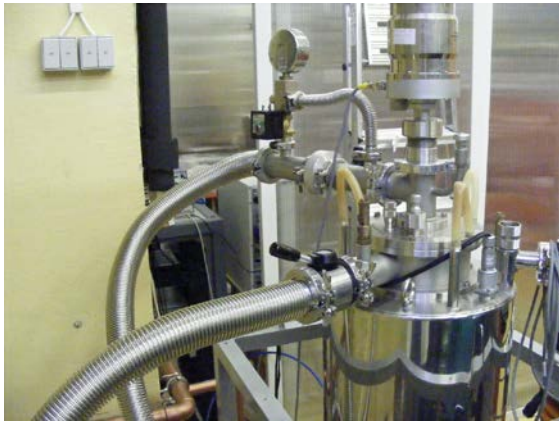
A mérő kriosztát felső része a hélium visszanyerés csatlakozásaival off-line pozícióban
