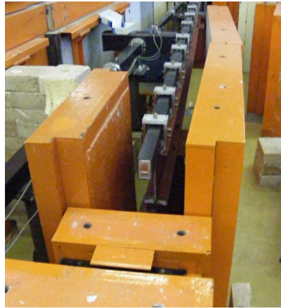
Az in-beam mérőhely neutronvezetője a végleges helyén
