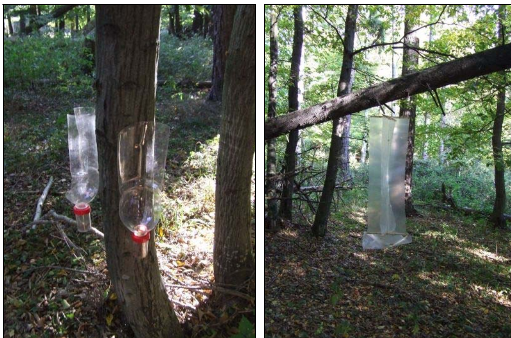
4-5. ábra: Ablakcsapda PET palackból (balra) és fóliából (jobbra)
