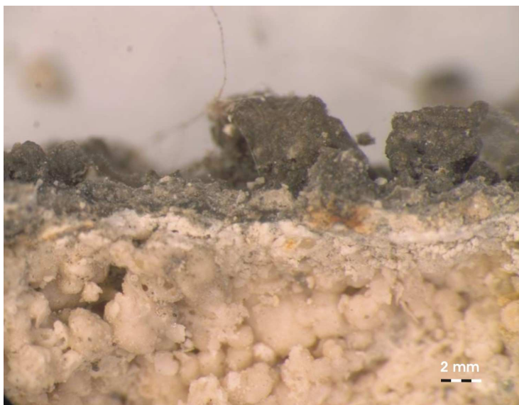
4. ábra. Ooidos mészővön kialakult gömbös fekete mállási kéreg egyenlőtlen érintkezési felülete és a kéreg alatti cementált világos színű kalcitos zóna (Török 2007b nyomán)
