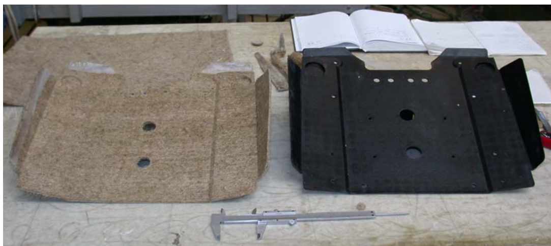
2. ábra Kender szállal erősített prototípus-termék, és az eredeti üvegszálás háttámla
