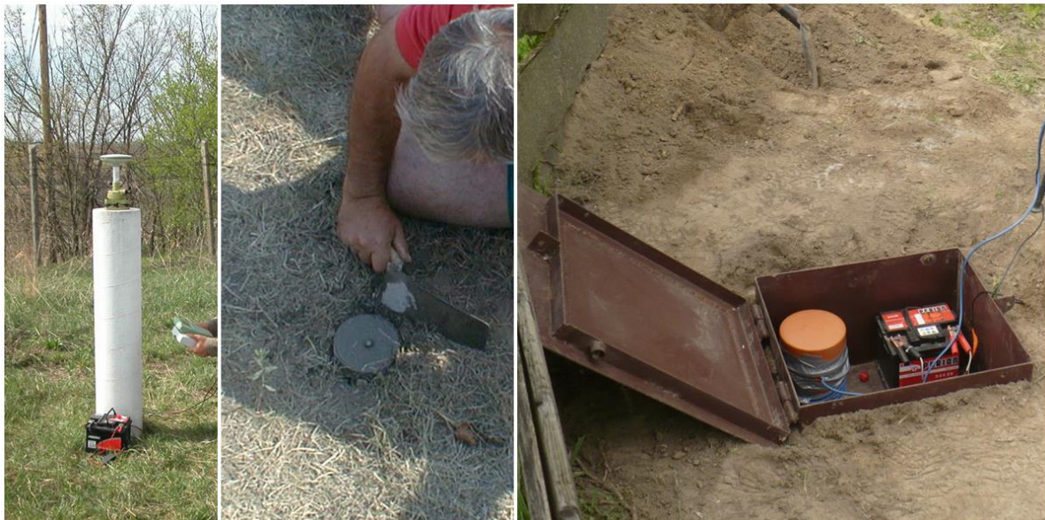
3 ábra. A mérőpillérek (balra), mozgásvizsgálati pontok (középen) és fúróluk dőlésmérő (jobbra) kiépítése.
