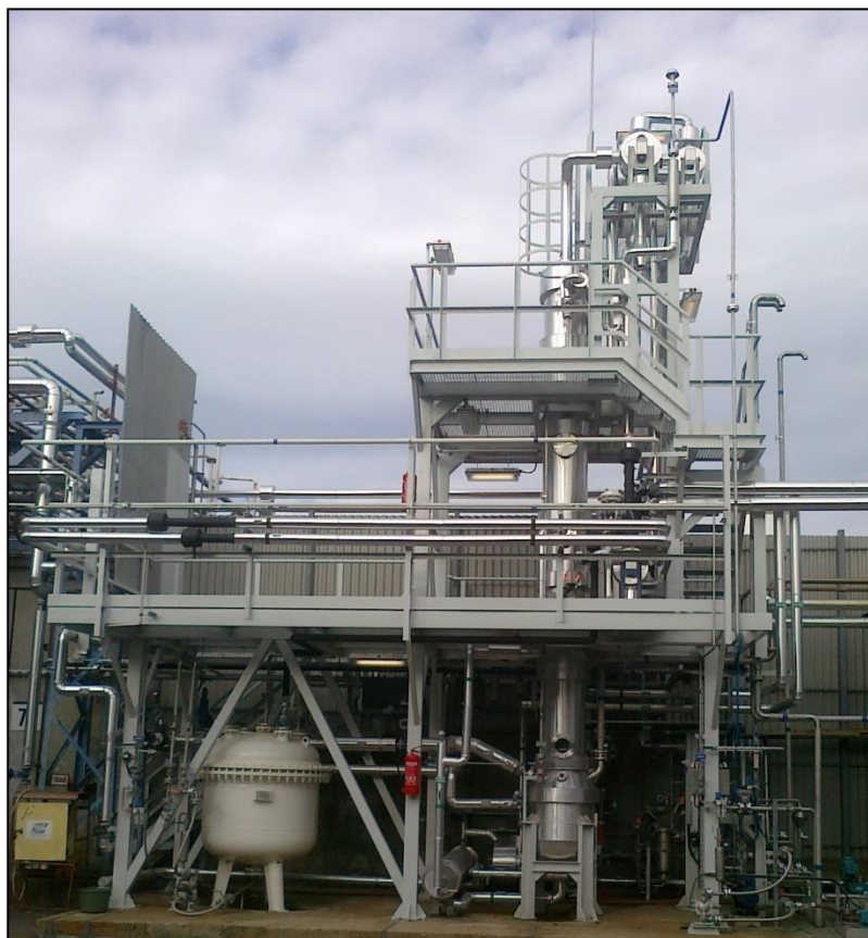
Diklór-metánt eltávolító oszlop a kutatócsoport eredményei és technológiai tervei alapján (2012)
