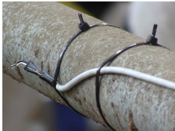
4. ábra: A közlekedőút mellett elhelyezett Voltcraft DL-181THP (a) és a pihenőbokszon rögzített Testo 175 H1 (b) hőmérséklet-páratartalom-mérő szenzorok
