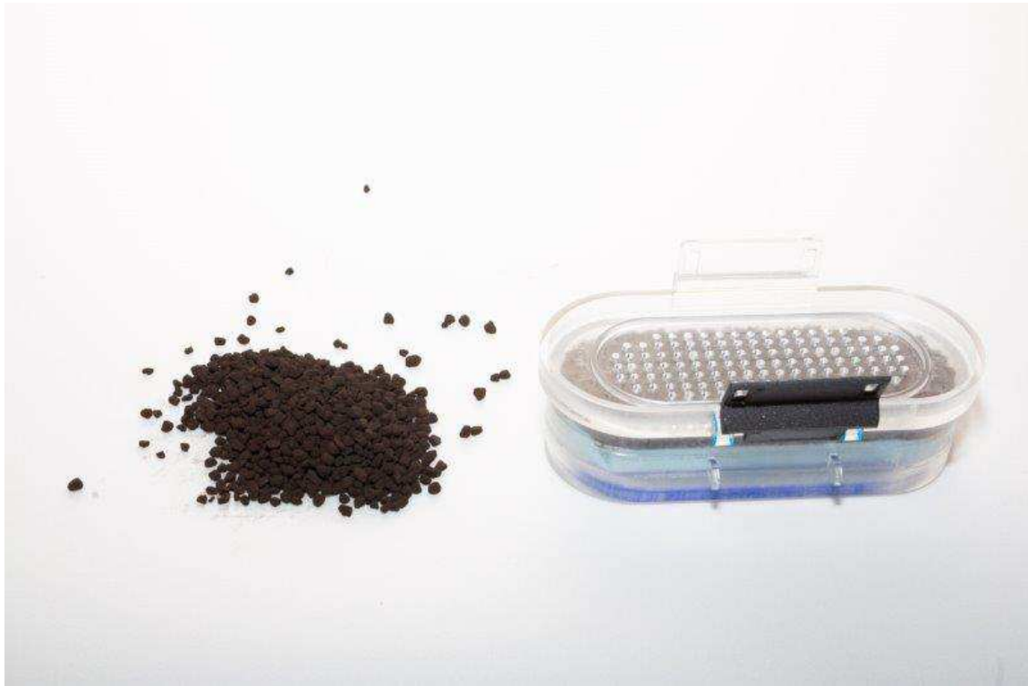
1. Ábra: A felhasznált katalizátor anyag és az elkészült szűrőszelence prototípusa
