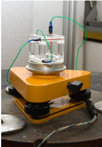
12. ábra. a) A FluxSet magnetométer a kalibráló-oszlop tetején. b) A mozgó acéltömeg mágneses hatása
