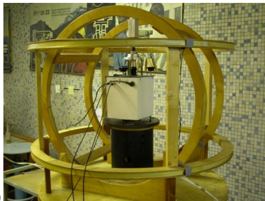
13. ábra. a) A Helmholtz-tekerces mérés elvi elrendezése. b) Az LCR G949 graviméter a Helmholtz-tekercesben
